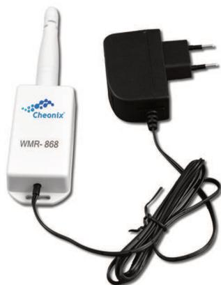
Il dispositivo è in grado di estendere, in modalità single-hop, la copertura di rete di dispositivi di campo Wireless M-Bus 868 MHz.
